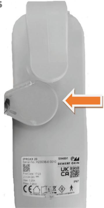
Verrouillage et déverrouillage des fonctions en posant le badge à l'arrière de la télécommande (confirmation par un bip)
